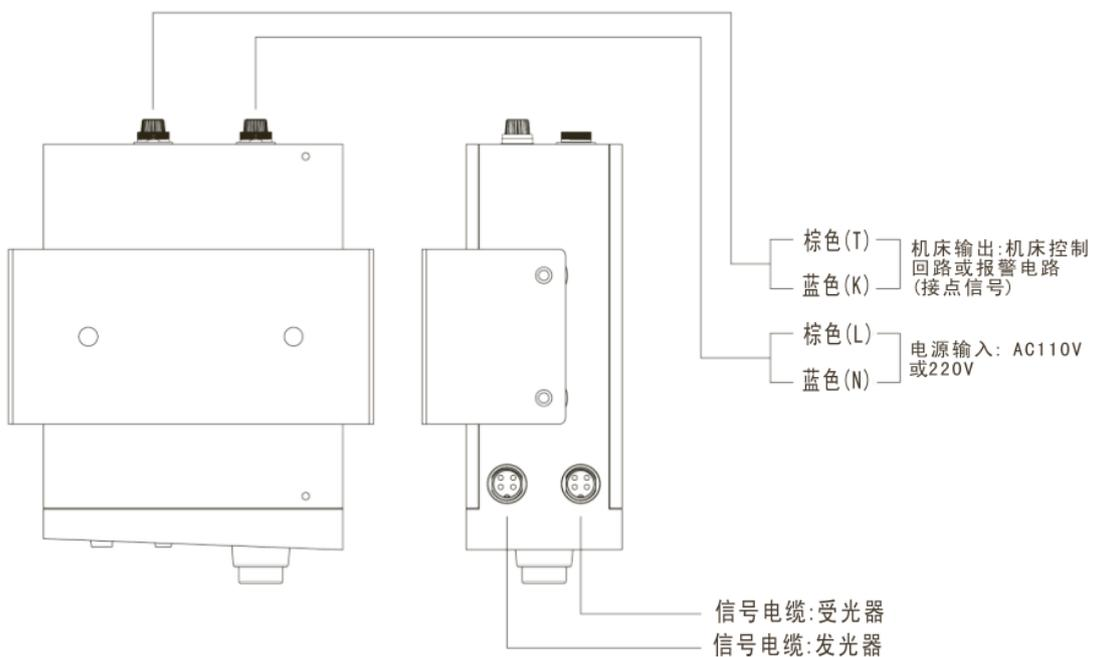
L（棕色）和 N（蓝色）为交流电源输入引线，输入电压为 AC110V/220V，检查接入电源，切勿接错。
